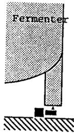
Wägezelle unter Beinstütze montiert
