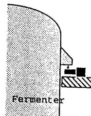
Wägezelle unter Aufhängevorrichtung montiert
