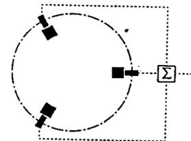
Standardanordnung bei Behälterwagen. Die Wägezellen werden sternförmig angebracht. Dadurch ist der Behälter autom. festgehalten.
